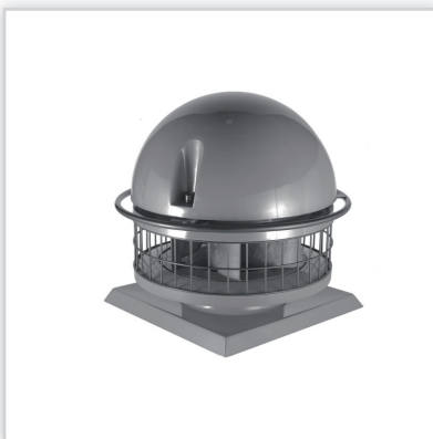
Wentylator dachowy DA (standard), DAK (kwasoodporny). Typ: DAs(k)160, 200, 250, 315, 400, 500, 630 DAs(k)-P2 i P3 (dwu- i trójbiegowy) 200, 250, 315. Obroty : 700, 900, 1400, 2800 obr./min-1. Wydajność [m 3 /h]: 200-36 000. Moc [kW]: 0,04/7,5. Napięcie [V]: 1 x 230 lub 3 x 400. Cisnienie akustyczne [dB(A)-(1 m)]: 51-89. Wykonanie : laminat poliestrowo-szkłany. Kolor : dowolny wg tabeli RAL. Cena netto [zł]: 1900-16 755.
