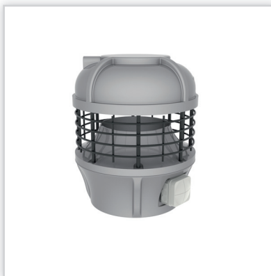
Hybrydowa, wywiewna nasada wentylacyjna MAG. Typ: MAG-200/AC lub EC dwubiegowy. Obroty [obr./min-1]: 1000/1400. Wydajność [m 3 /h]: 150-450. Moc [kW]: 12-70. Napięcie [V]: 1 x 230VAC 50-60 Hz. Cisnienie akustyczne [dB(A)-(1 m)]: 33/45. Wykonanie : laminat poliestrowo-szkłany. Kolor : dowolny wg tabeli RAL. Cena netto [zł]: 1860-2580.
